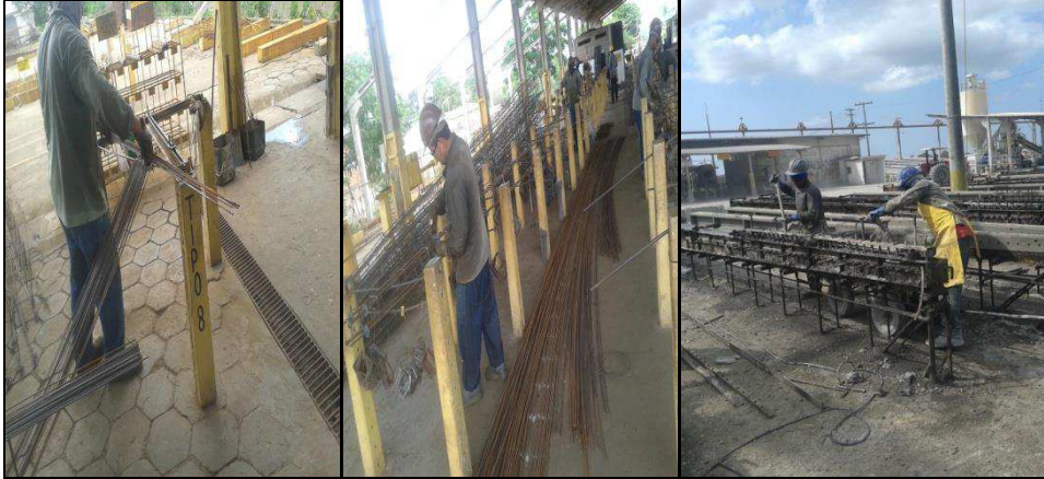
Figura 1: Sequencia dos processos de fabricação de quadros, armação e enchimento dos postes DT 300/9
