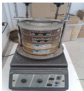
Figura 23 - Agitador mecânico de peneiras.
