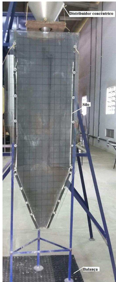
Figura 19 - Conjunto distribuidor, silo e balança.
