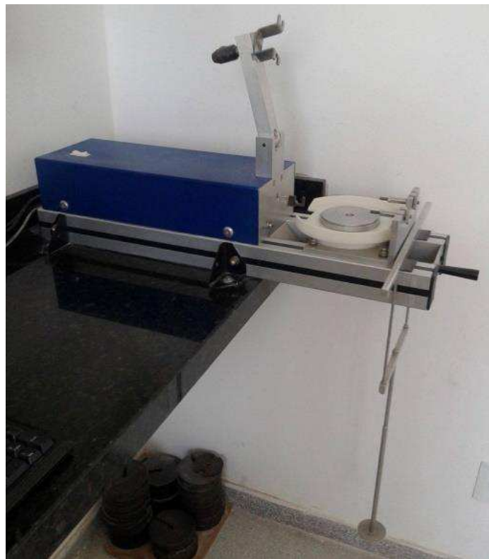
Figura 22 - Jenike Shear Cell, utilizado para determinação das propriedades de fluxo.
