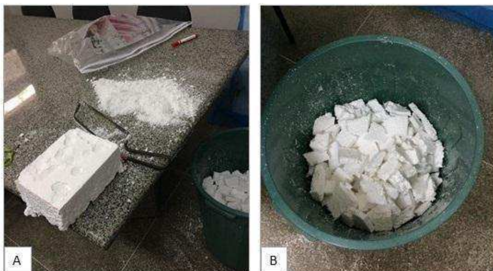
Figura 15 - Preparação do substrato inorgânico em 2019. A) Processo manual de redução do EPS. B) EPS triturado. Campina Grande – Paraíba (Brasil)
