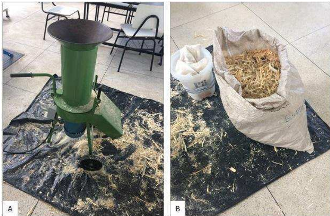
Figura 14 - Preparação do substrato orgânico em 2019. A) Equipamento de desfibramento (forrageira adaptada). B) Bagaço da cana-de-açúcar desfibrado. Campina Grande - Paraíba (Brasil)
