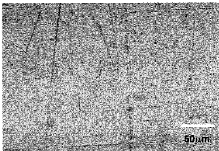
Figura 24 - PS fotodegradado por 30 dias, não submetido a qualquer outro tipo de ensaio ou meio de exposição. Os riscos presentes são apenas de marcas do molde ou manuseio.
