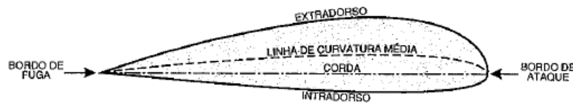
Figura 4 – Nomenclatura do perfil de asa
