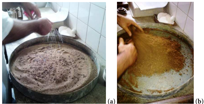
FIGURA 27 - (A) ADIÇÃO DE ÁGUA DESTILADA; (B) REVOLVIMENTO PARA HOMOGENEIZAÇÃO DA UMIDADE NA AMOSTRA
