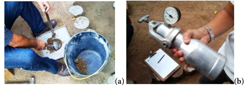
FIGURA 36 - (A) RETIRADA DO MATERIAL DA CAVIDADE; (B) MÉTODO DO SPEEDY
