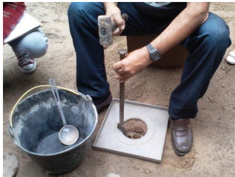
FIGURA 35 - ESCAVAÇÃO DA CAVIDADE RESPEITANDO OS LIMITES DO ORIFÍCIO DO CENTRO DA BANDEJA
