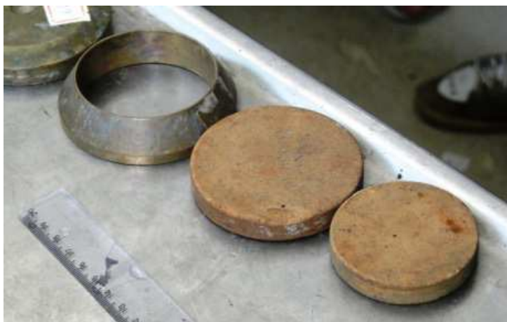
FIGURA 51 - ANEL E PEDRAS POROSAS PARA REALIZAÇÃO DO ENSAIO
