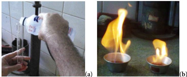
FIGURA 09 - (A) ADIÇÃO DE 15 ML DE ÁLCOOL ETÍLICO; (B) COMBUSTÃO NAS AMOSTRAS
