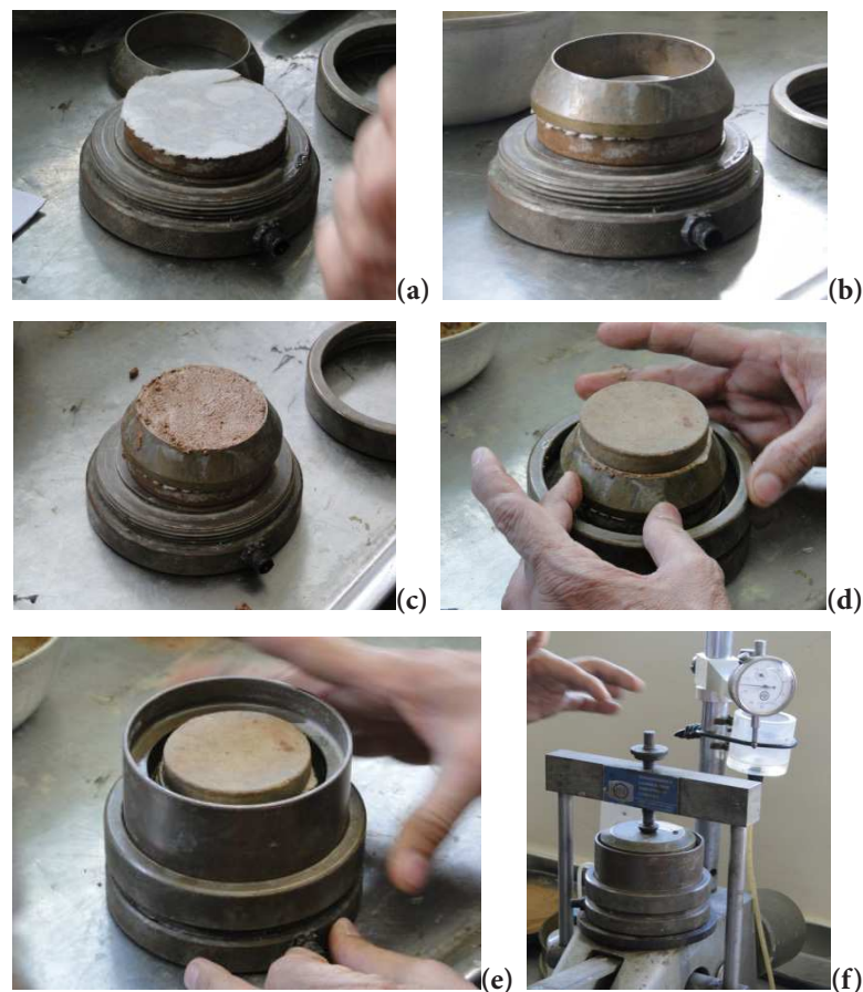
FIGURA 52 - (A) BASE RÍGIDA, PEDRA POROSA E PAPEL FILTRO; (B) ANEL; (C) CORPO DE PROVA CONTIDO NO ANEL; (D) PAPEL FILTRO E PEDRA POROSA SUPERIOR; (E) DISCO; (F) CABEÇOTE METÁLICO E CONJUNTO AJUSTADO AO SISTEMA DE APLICAÇÃO DE CARGA
