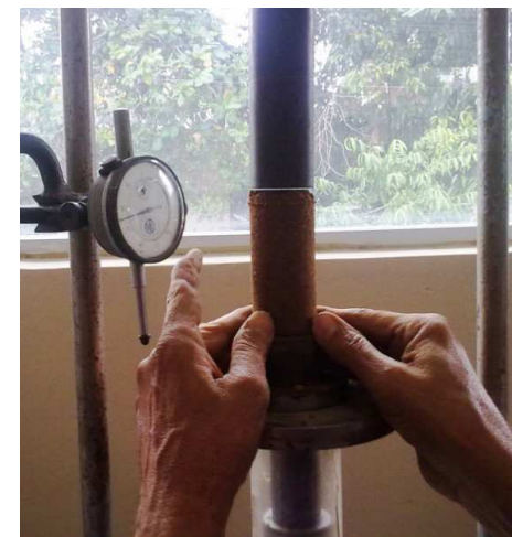
FIGURA 75 - CORPO DE PROVA NO PEDESTAL SEM CONFINAMENTO
