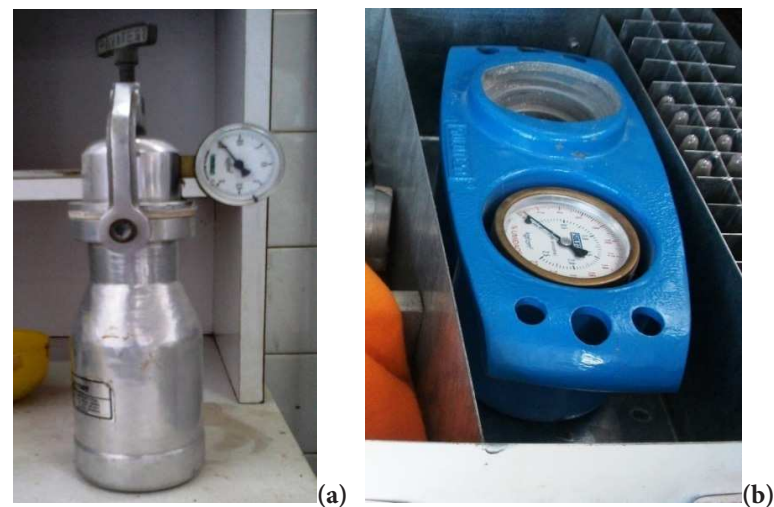
FIGURA 10 - (A) APARELHO DE SPEEDY CONVENCIONAL, COM LEITOR APENAS DE PRESSÃO; (B) APARELHO DE SPEEDY , COM DUAS ESCALAS, UMA DE PRESSÃO E OUTRA DE UMIDADE
