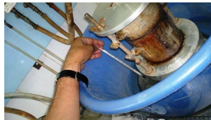
FIGURA 49 - MEDIÇÃO DE TEMPERATURA DA ÁGUA
