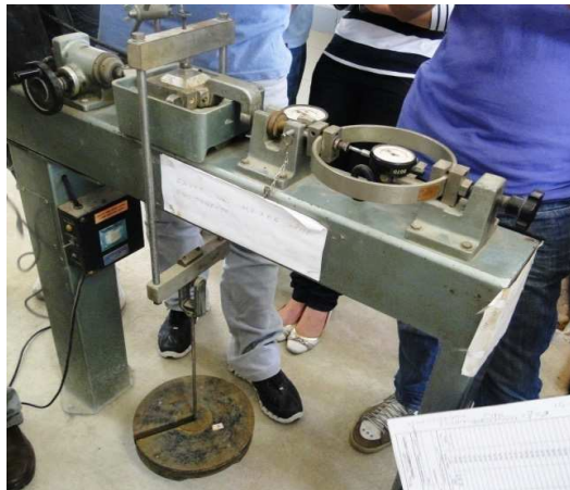
FIGURA 65 - PENDURAL E PESOS PARA APLICAÇÃO DO CARREGAMENTO
