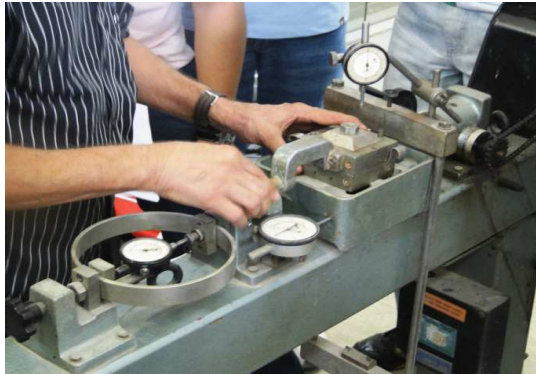
FIGURA 64 - INSTALAÇÃO DA CAIXA DE CISALHAMENTO NA PRENSA
