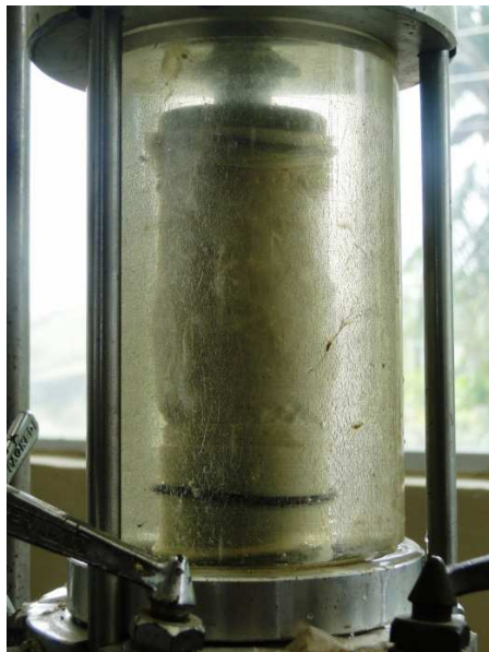
FIGURA 74 - RUPTURA DO CORPO DE PROVA
