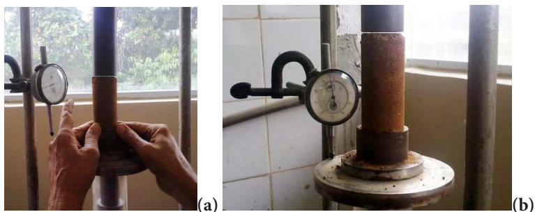
FIGURA 79 - (A) COLOCAÇÃO DO CORPO DE PROVA NO PRATO INFERIOR; (B) AJUSTA-SE NA PARTE SUPERIOR E ZERA-SE O MEDIDOR
