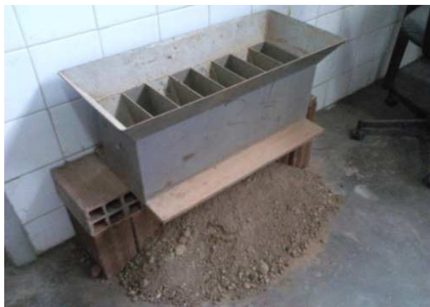
FIGURA 05 - QUARTEAMENTO DA AMOSTRA DE SOLO
