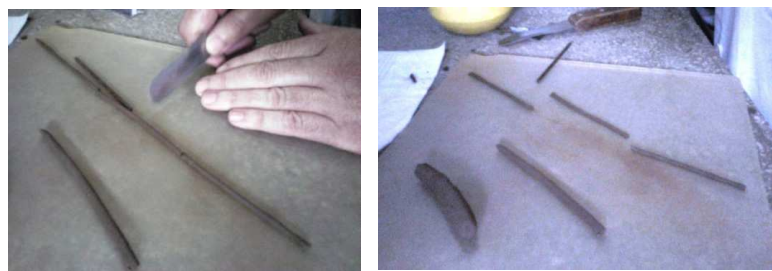
FIGURA 19 - REPARTIÇÃO DA AMOSTRA EM CILINDROS DE 10 CM DE COMPRIMENTO, APROXIMADAMENTE
