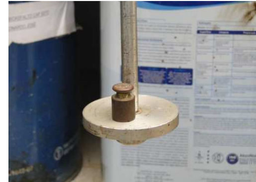
FIGURA 54 - CARGA POSTA PARA APLICAÇÃO DO PRÉ-ADENSAMENTO
