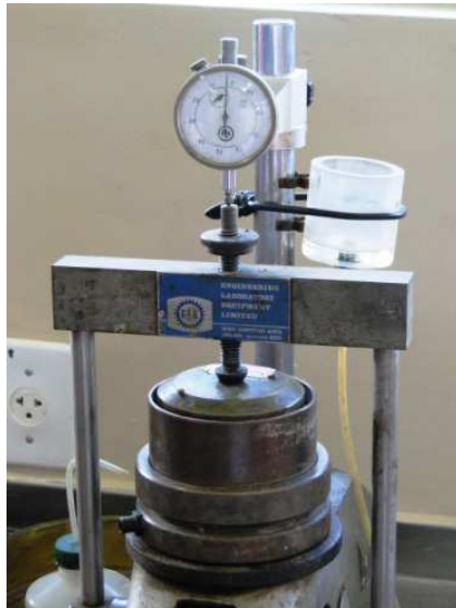
FIGURA 53 - DESTAQUE PARA RECIPIENTE DE SATURAÇÃO DA AMOSTRA DURANTE O ENSAIO, À DIREITA
