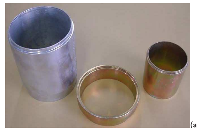
FIGURA 03 - (A) CILINDROS E ANÉIS BISELADOS PARA RETIRADA DE AMOSTRAS INDEFORMADAS; (B) COLETA DE AMOSTRA INDEFORMADA EM BLOCO - BASE DE ATERRO COMPACTADO
