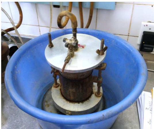
FIGURA 48 - PERMEÂMETRO MONTADO PARA REALIZAÇÃO DE ENSAIO
