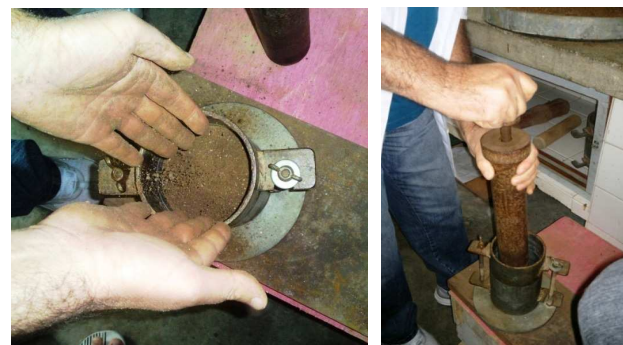
FIGURA 29 - COLOCAÇÃO DAS CAMADAS E APLICAÇÃO DOS GOLPES
