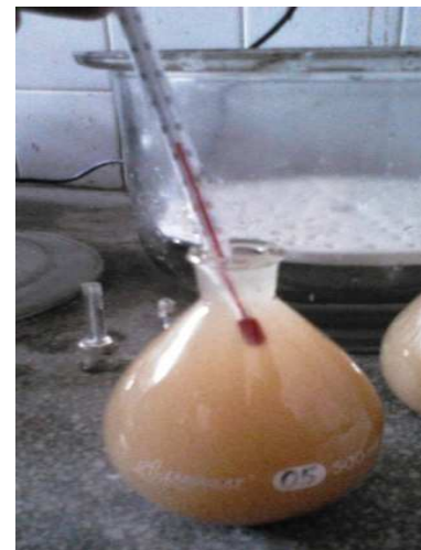
FIGURA 13 - MEDIÇÃO DE TEMPERATURA DO CONTEÚDO DO PICNÔMETRO
