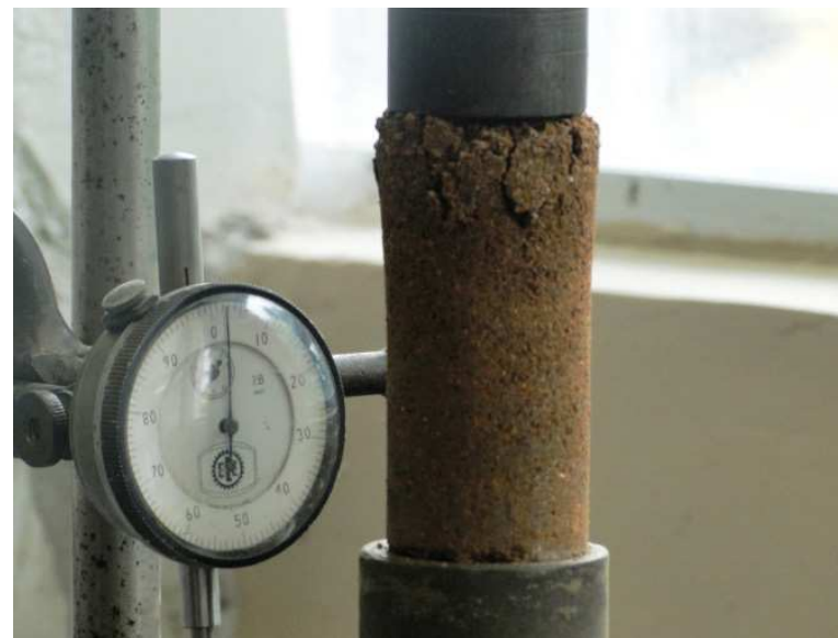
FIGURA 80 - ROMPIMENTO DO CORPO DE PROVA
