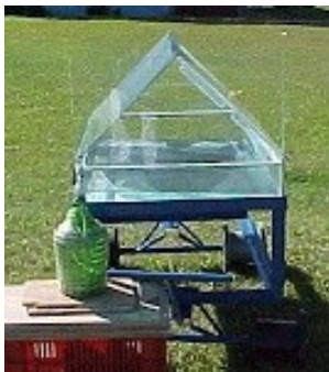
Destilador solar retangular e com cobertura piramidal.
