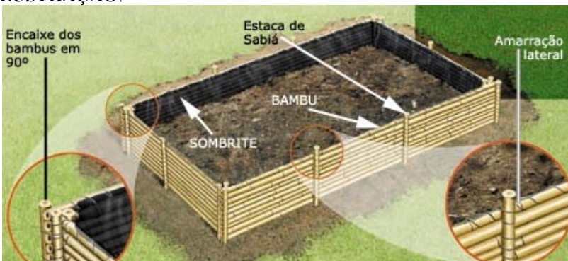
Figura 1. Esquema de minhocário campeiro em estrutura tramada.
