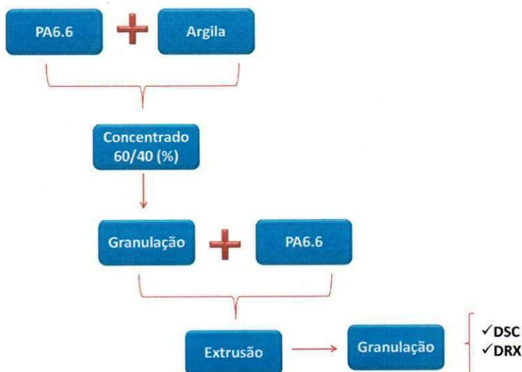
Importante salientar que antes de qualquer processamento, a poliamida 6.6 e seus nanocompósitos foram secos em estufa de ar circulante durante 2 horas a 80 °C e em seguida, foram colocados em estufa à vácuo, a 80 °C por 24 horas.
