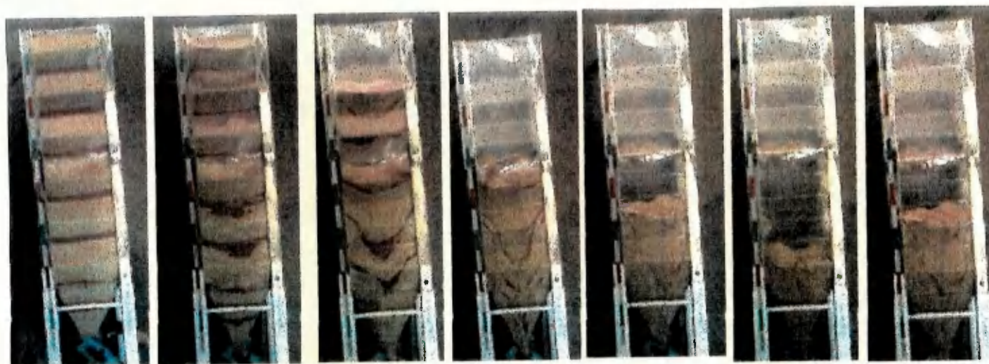
FIGURA 22 - Fluxo de massa para a ração 2 com H/L igual a 3,5 e seção transversal da boca de saída 64cm 2
