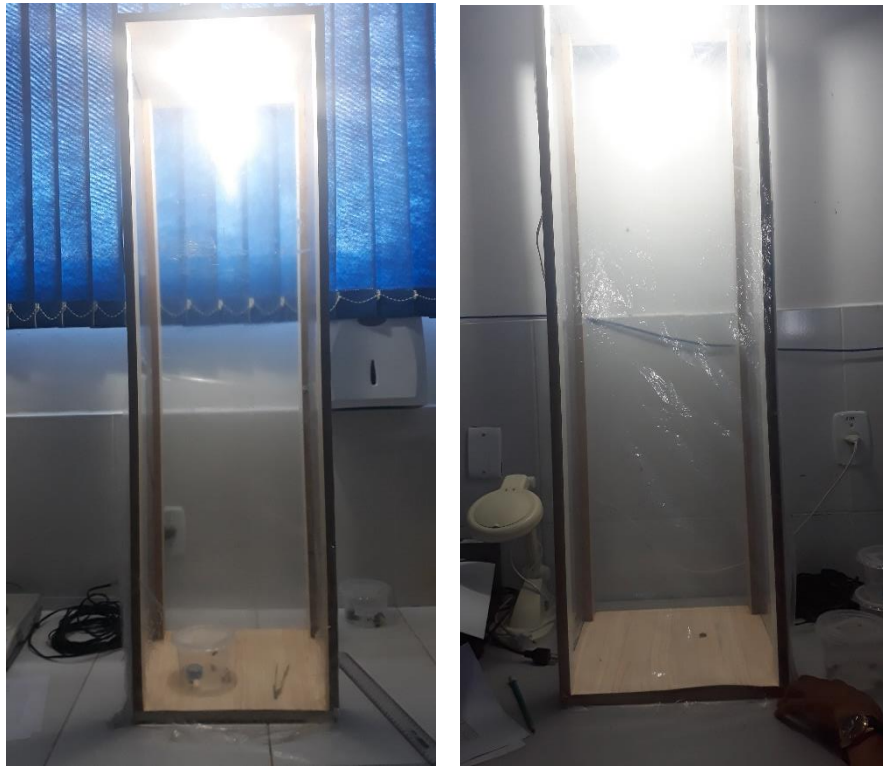
Figura 5: Torre de voo medindo 115 cm de altura com uma lâmpada no topo para atrair as abelhas. Fonte: Autoria própria.
