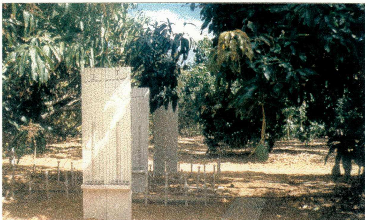
Figura 3.5 - Posicionamento das baterias de tensiômetros no interior do pomar de mangueiras, cv. 'Tommy Atkins', em Petrolina, PE, em 1999
