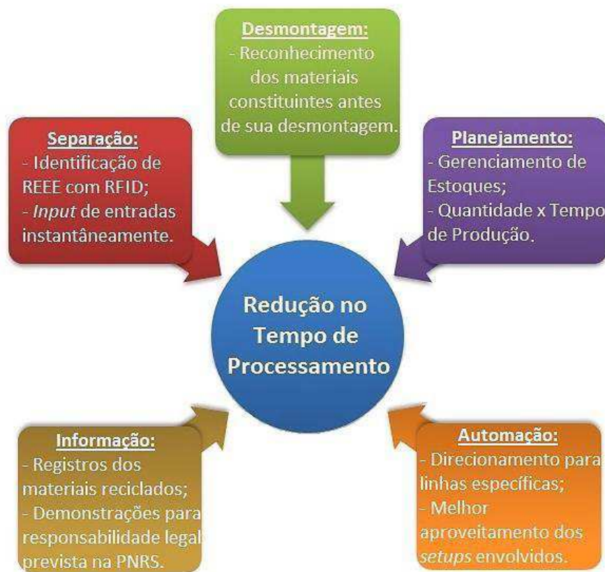
Figura 5 - Benefícios do Tempo de Processamento de REEE através do RFID
