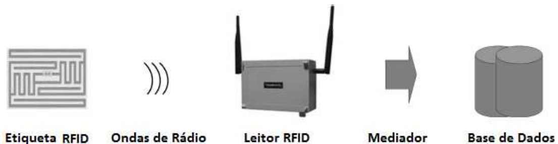
Figura 2 - Os elementos básicos da tecnologia RFID são etiquetas, leitores e mediador
