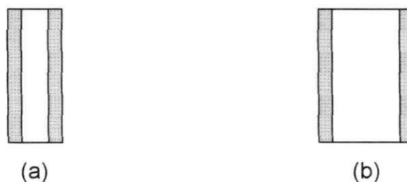
Figura 4.5- Corpo de prova, vista perpendicular, com espessura de 0,5mm (a) e Corpo de prova, vista perpendicular, com espessura de 3mm (b).
