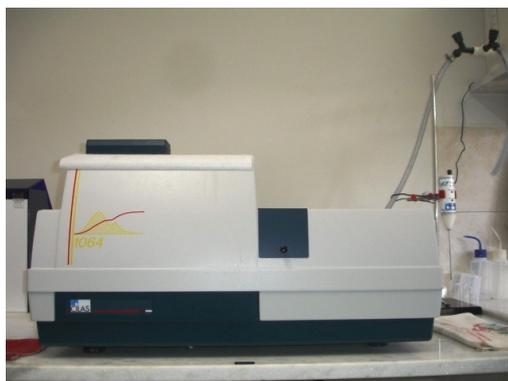
**Figura 3 - Equipamento utilizado para realização do ensaio de difração a laser**
