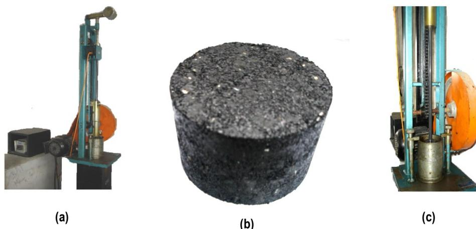
**Figura 5 - Equipamentos utilizados para realização da compactação dos corpos-de-prova (a) Compactador (b) Corpo-de-prova (c) Soquete + Cilindro**
