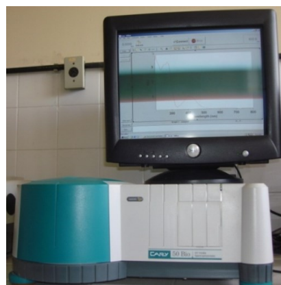
Figura 4 - Espectrofotômetro Marca VARIAN, modelo CARY 50 Bio.
