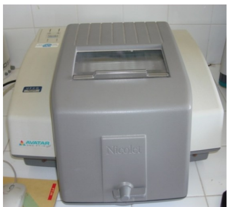
Figura 3 - Espectrofotômetro marca Nicolet, AVATAR 360 FT-IR.
