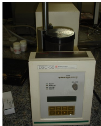
Figura 2 - Calorímetro Modelo DSC-50, marca SHIMADZU.
