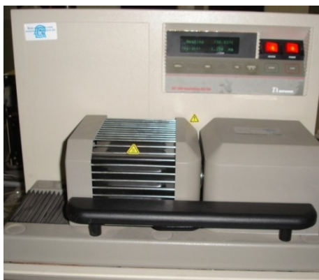
Figura 1 - Termobalança, marca TA Instruments, modelo SDT 2960.
