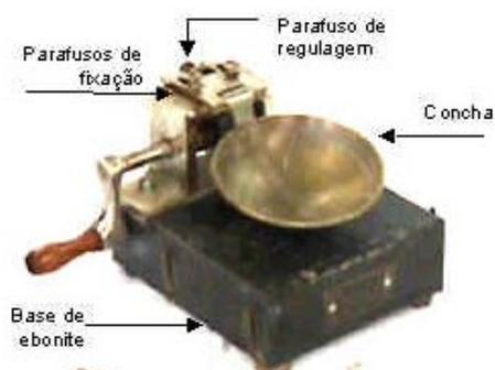
Figura 1 – Aparelho de Casagrande
