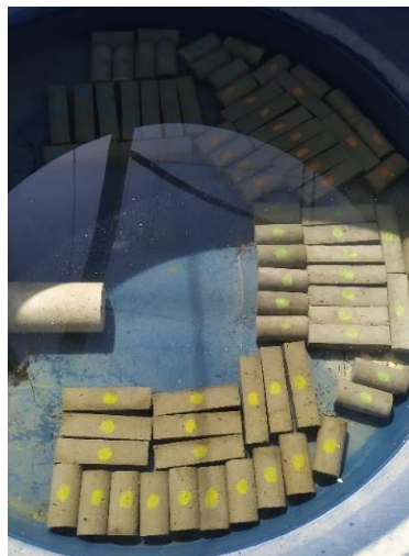
Figura 8 – Tanque de cura (Fonte: O autor, 2023)
