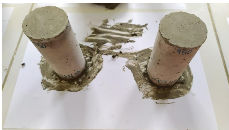
Figura 13 – Capeamento dos corpos de prova (Fonte: O autor, 2023)
