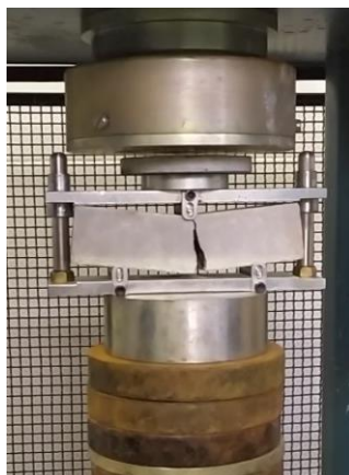
Figura 18 – Execução do ensaio de tração na flexão (Fonte: O autor, 2023)
