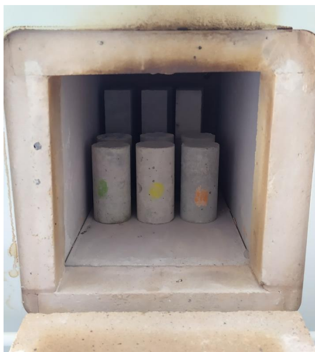
Figura 11 – Corpos de prova na mufla (Fonte: O autor, 2023)
