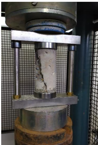
Figura 17 – Execução de ensaio de compressão (Fonte: O autor, 2023)
