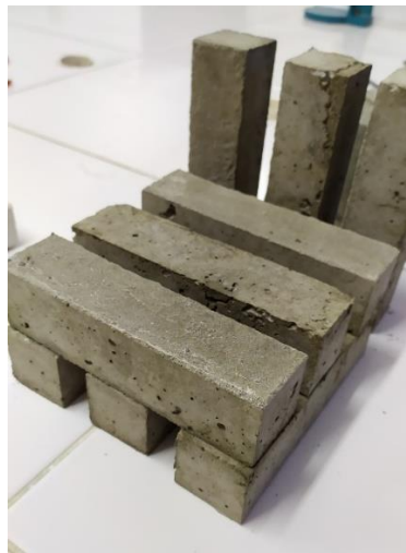
Figura 7 – Corpos de prova prismáticos (Fonte: O autor, 2023)
