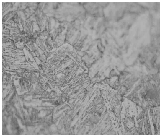
(b) Linha de fusão – Detalhe de bainita + martensita - 500x
