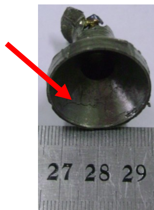
Figura 8. Produto inacabado da fusão e detalhe indicando trincas.
