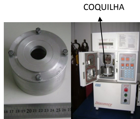
Figura 3. Detalhe da coquilha de alumínio e montagem na máquina de fusão a plasma.
