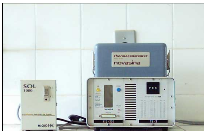
Figura 2: Equipamento Thermoconstanter Novasina TH-2, utilizado para determinação da atividade de água
