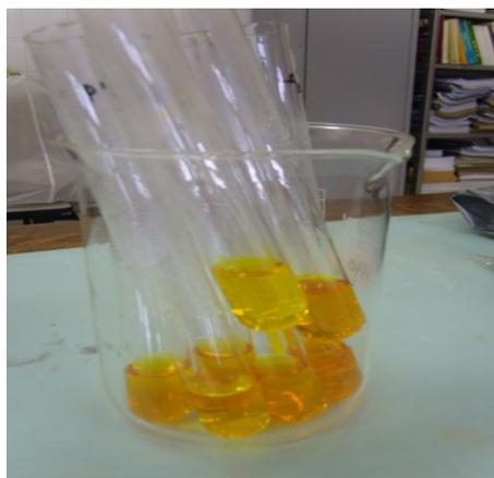
Figura 5 – Solução após banho em água fervente pronta para leitura de absorbância.
