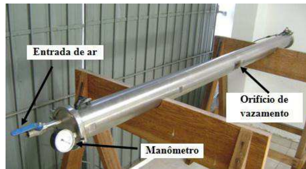
Figura 2.9: Seção experimental de duto de aço inox. Fonte: Garcia et al. (2011)
