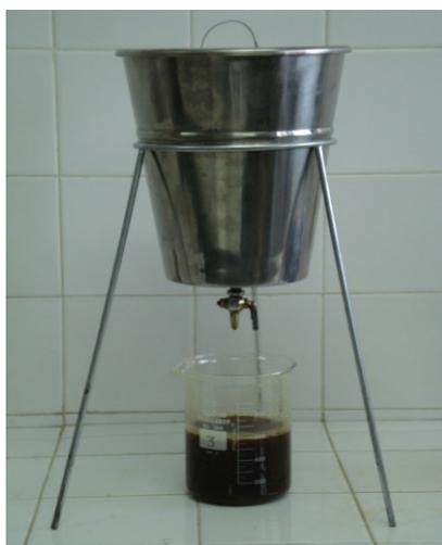
Figura 1. Percolador utilizado na extração dos extratos
