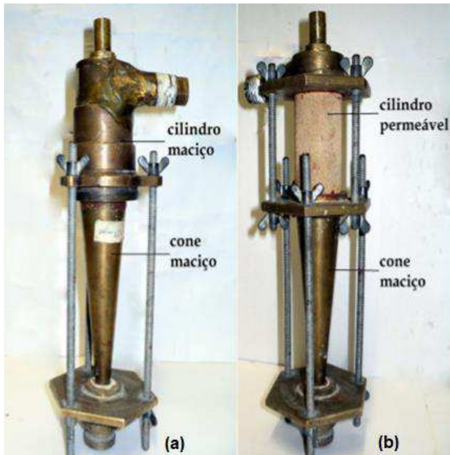
Figura 4.1: (a) Hidrociclone convencional (Hcon), (b) hidrociclone cilíndrico filtrante (HciF). Adaptado de Façanha (2012).
