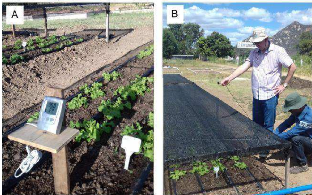
Figura 1 - Utilização do Termohigrômetro (A) para medição da temperatura e da umidade relativa do ar e do Ceptômetro (B) para medição da radiação incidente na parte superior e inferior das tela de sombreamento. UEPB/CCHA. Catolé do Rocha-PB, 2017.
