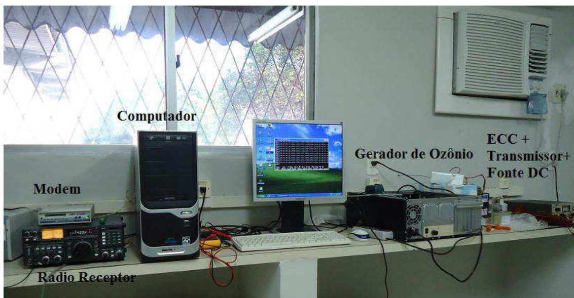
Figura 3-12 - Ambiente experimental para medição do nível de O_3 utilizando ECC.
