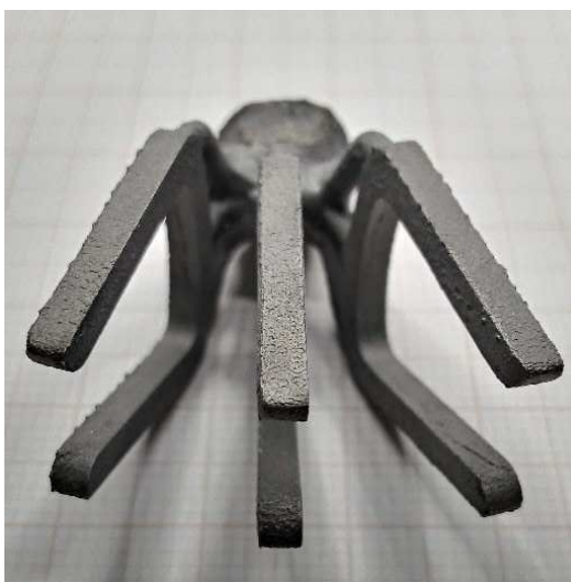
Figura 40. Fotografia do modelo fundido do grampo ortopédico denso com \alpha = 12,5^\circ fabricado com a liga base EBM .
