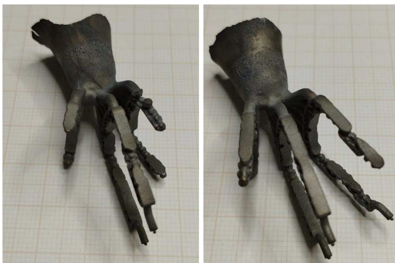
Figura 39. Fotografias dos modelos fundidos dos grampos ortopédicos porosos com \alpha = 7,5^\circ fabricados com a liga base VIM com parâmetros de pressão de Ar/vácuo.
