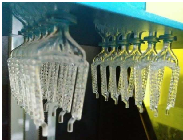
Figura 33. Modelos em resina dos grampos ortopédicos porosos sob a plataforma.
