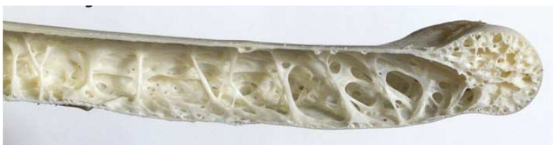
Figura 10. Fotografia de material celular poroso do osso da asa de um pássaro.
