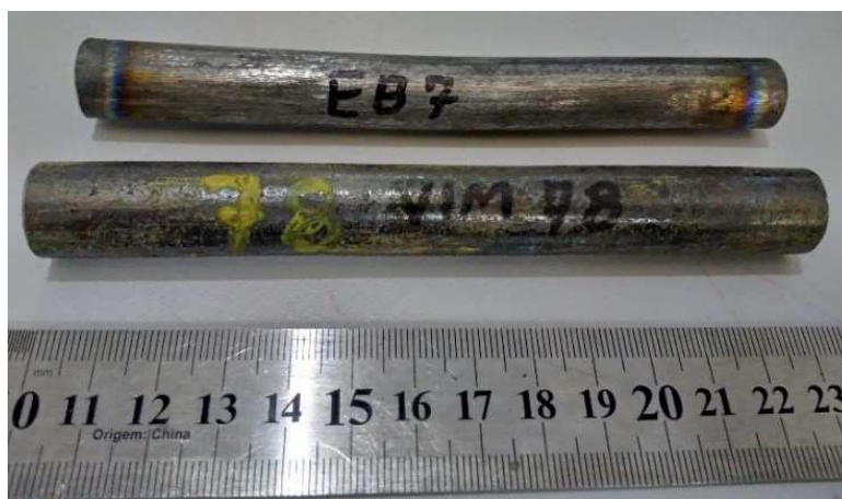
Figura 23. Fotografia das barras redondas de Ni-Ti fabricadas pelos processos VIM e EBM .
