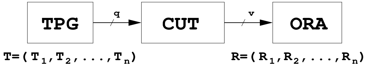
Figura 1.2: Arquitetura básica dos circuitos integrados autotestáveis (BIST). Em que o TPG é o gerador de testes, CUT é o circuito sob teste e o ORA é o analisador de respostas.
