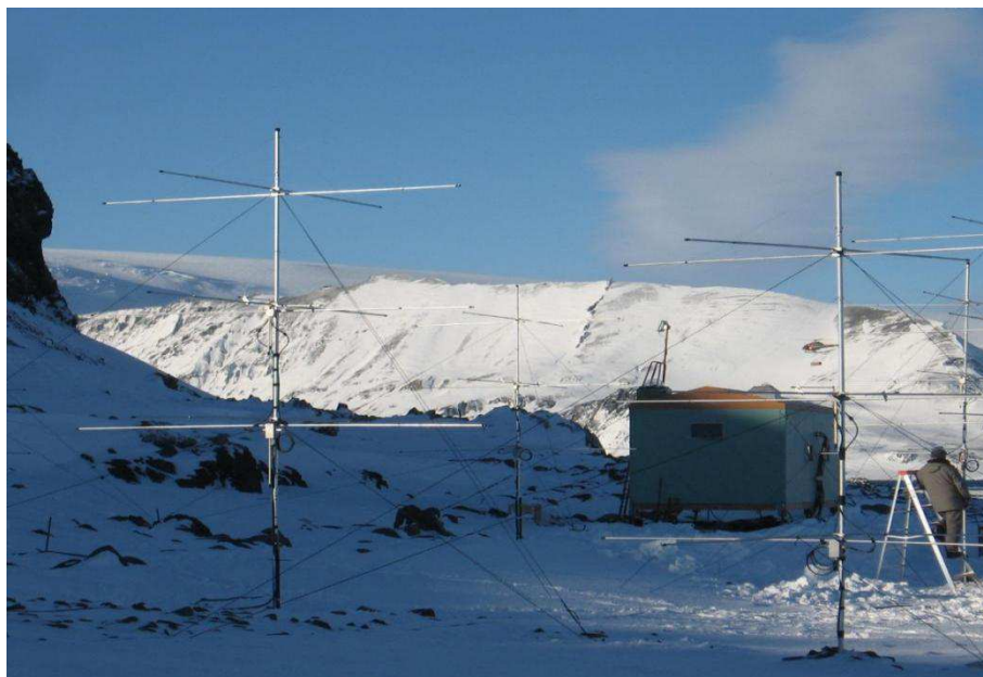
Figura 3.3 - Antenas transmissoras do Radar DrAAMER. Fonte: Cedida gentilmente por José Valentin Bageston.
