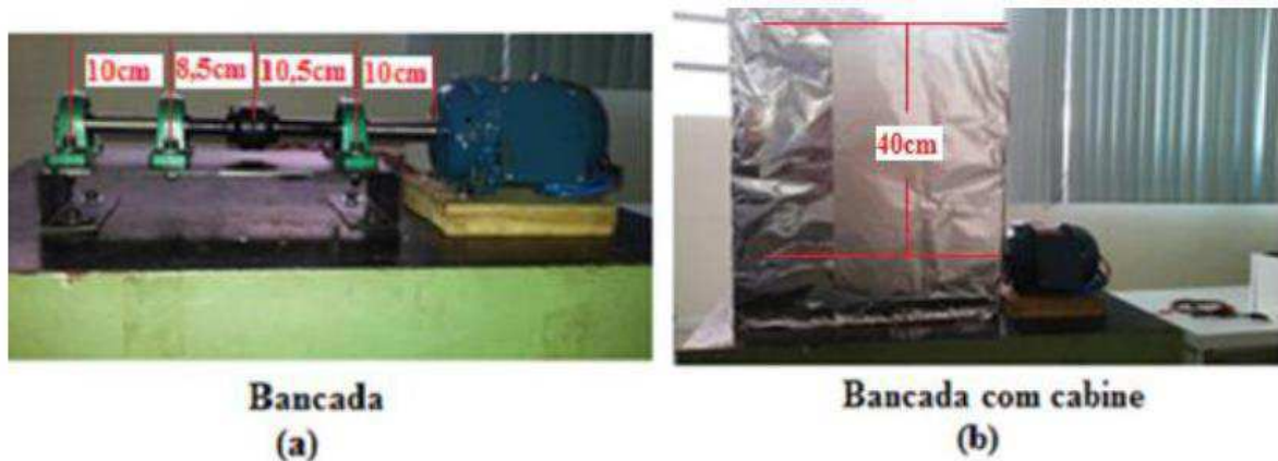
Figura A 3 - Bancada de testes com (b) e sem (a) a cabine para isolamento térmico
