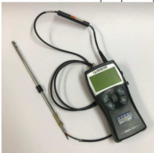
Figura A 12 - Termo-anemômetro com sonda de fio quente para medição de velocidade do ar
