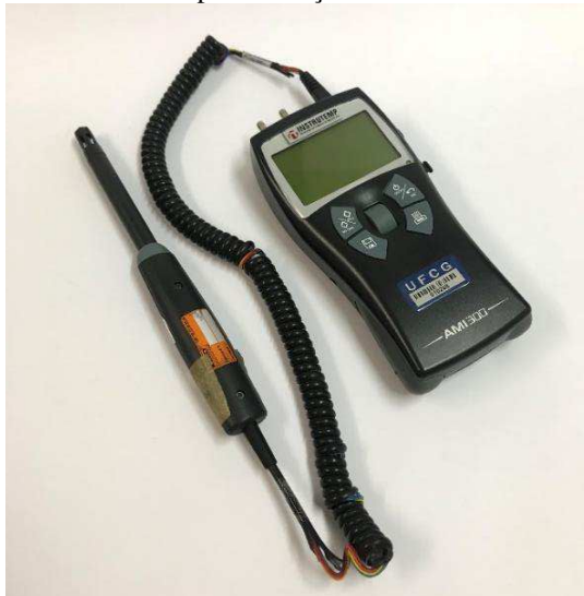
Figura A 11 - Termo-anemômetro com sonda para medição de umidade relativa do ar e temperatura ambiente
