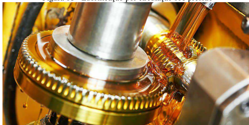
Figura 18 - Lubrificação por circulação sob pressão
