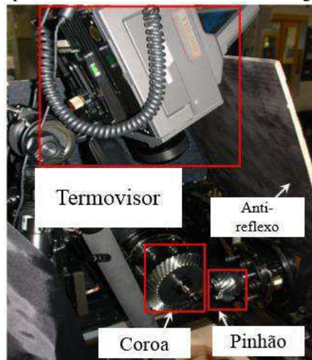
Figura 61 - Bancada experimental para analisar contato dentário dentre engrenagens por meio da Termografia
