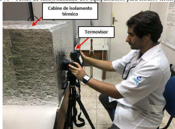
Figura 70 - Testes de funcionalidade dos equipamentos para ensaios termográficos
