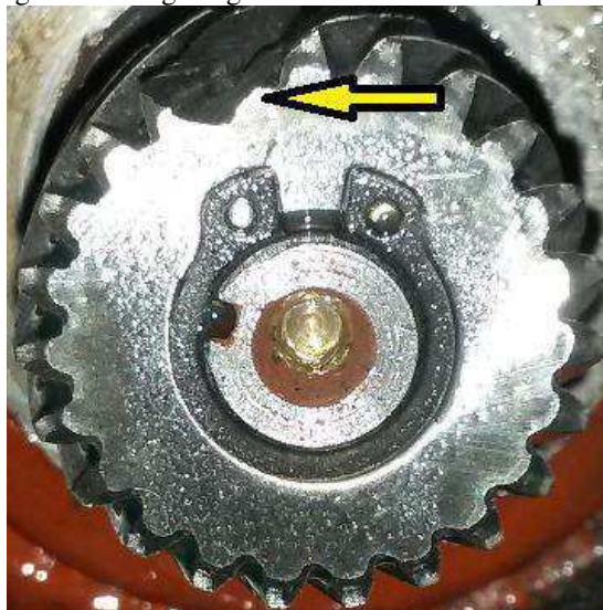
Figura 46 - Engrenagem motora com o dente quebrado
