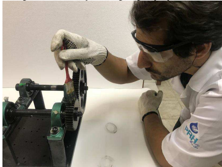
Figura 74 - Lubrificação das engrenagens por pincelamento
