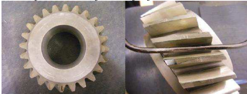
Figura 43 - Teste de fadiga em uma engrenagem helicoidal com indutor
