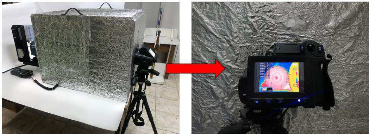
Figura 82 - Enquadramento do pinhão pelo termovisor
