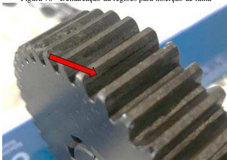
Figura 76 - Demarcação da regiões para inserção de falha
