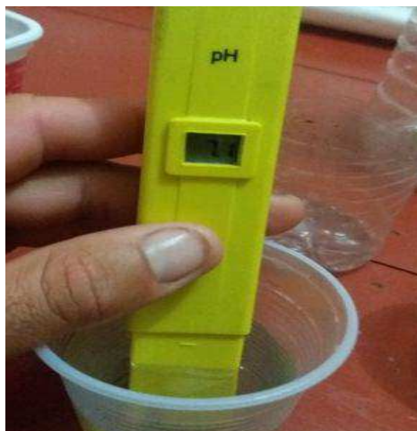
Figura 23. Imagens da determinação de pH após o processo de filtragem.
