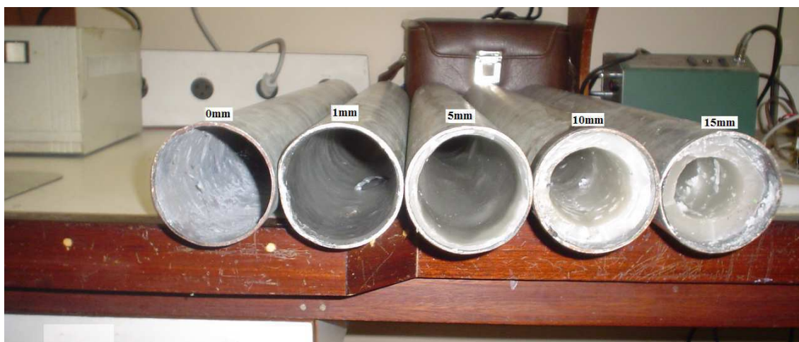
Figura 6.7: Fotografia da vista transversal das tubulações utilizadas.
