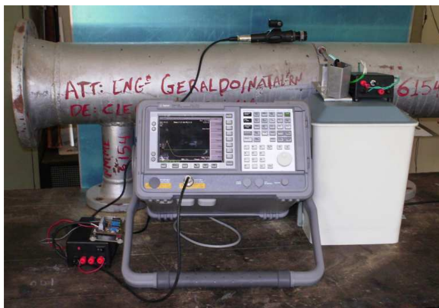
Figura 6.38: Fotografia da montagem utilizada nos testes com uma tubulação real.
