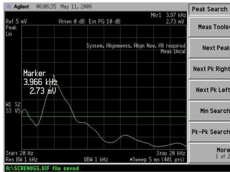
Figura 6.15: Representação do sinal de saída do microfone, no domínio da frequência, para o tubo sem incrustação (com água).
