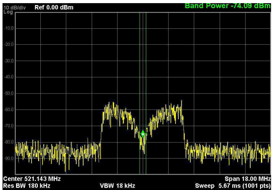
Figura 6.4 Canal de transmissão com uma componente de multipercurso com um desvio de fase de 180 graus.
