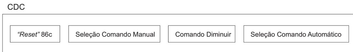
Figura 6.3: Diagrama em Blocos da Representação da Sub-Rede que Modela um Comutador de Derivação em Carga.
