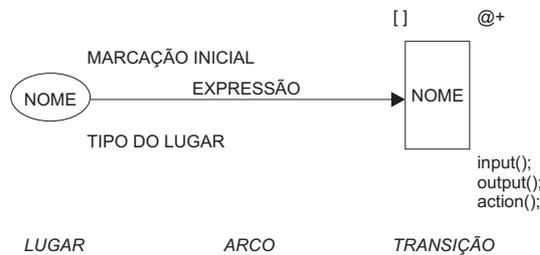
Figura 3.6: Elementos Básicos de uma Rede de Petri Colorida: *LUGAR*, *ARCO* e *TRANSIÇÃO*.
