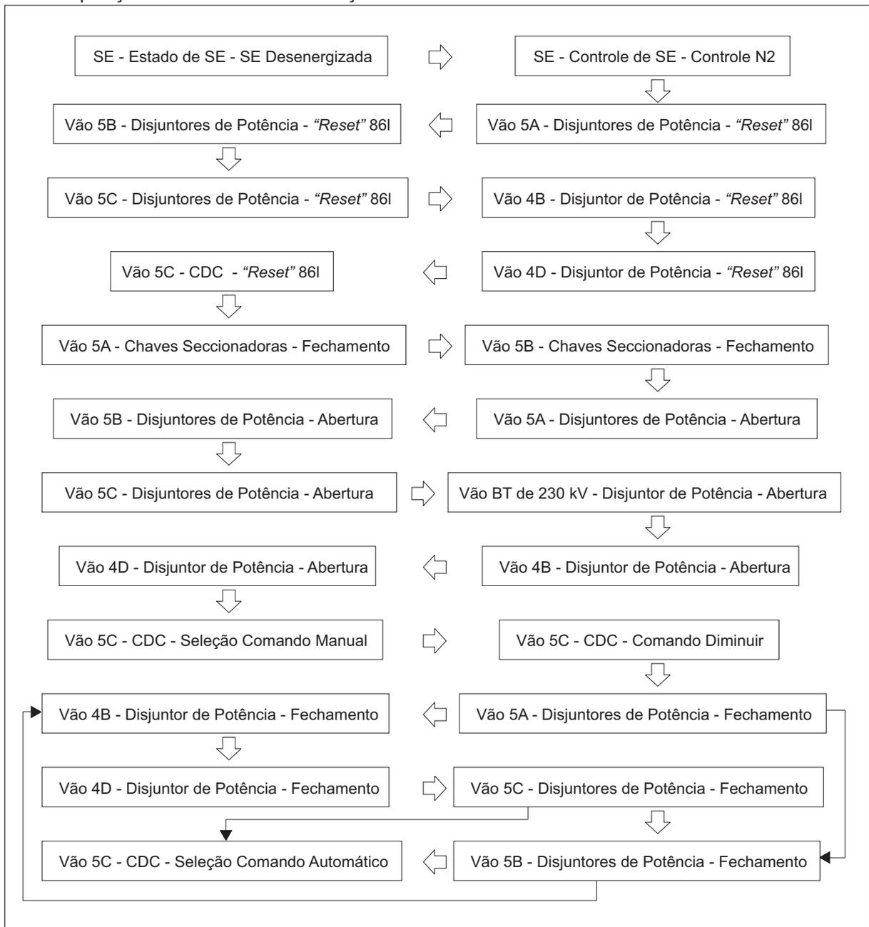
Figura 6.13: Diagrama em Blocos Detalhado da Integração dos Modelos de Redes.
