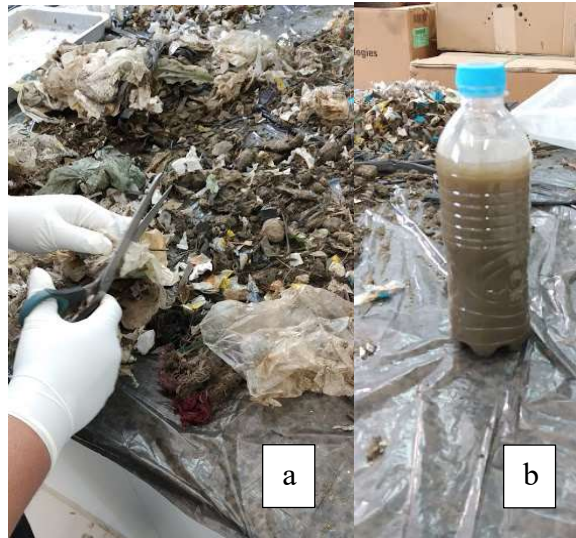
Figura 16 – Preparação de amostra: (a) picotagem; (b) extrato
