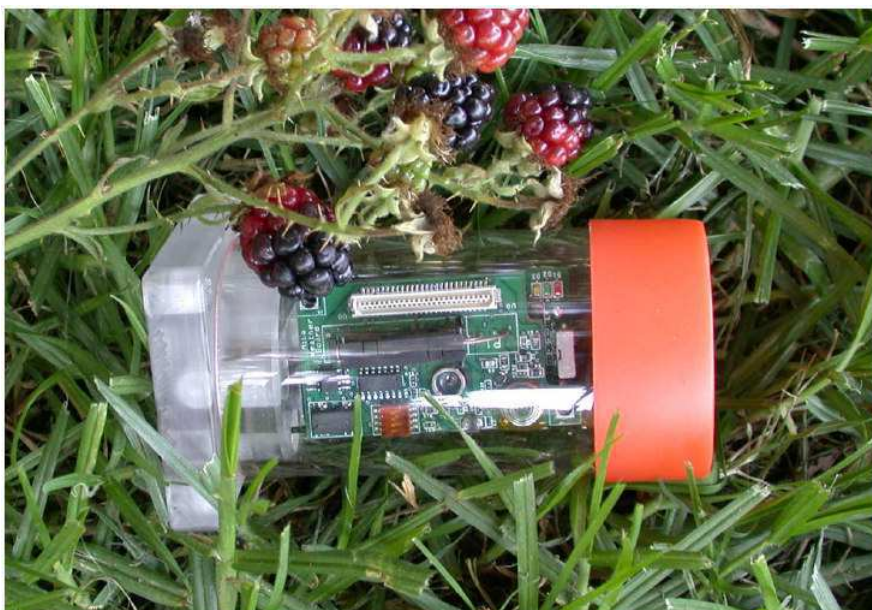
Figura 2.8 O nó sensor em uma cápsula de acrílico para proteção.
