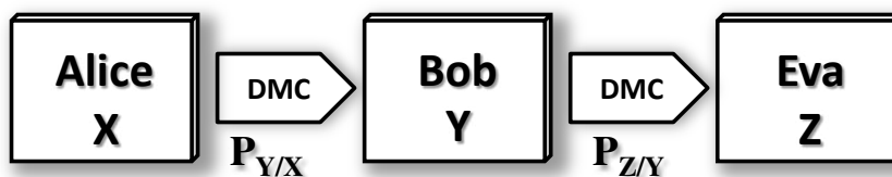
Figura 3.2 Canal grampeado de Wyner.
