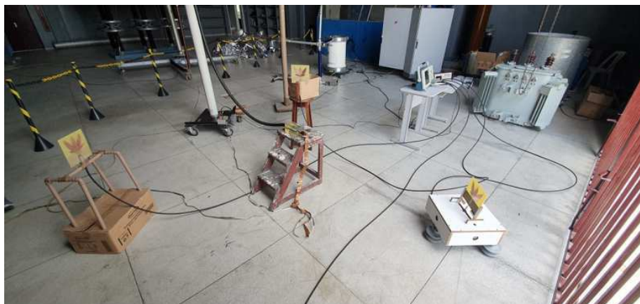
Figura 4.10 – Arranjo experimental 1: visão das antenas distribuídas ao redor do objeto de teste.
