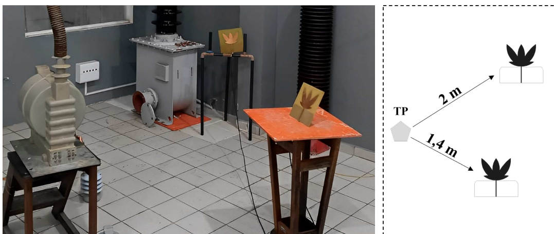
Figura 4.11 – Arranjo experimental 2: distância entre as antenas e o objeto teste.
