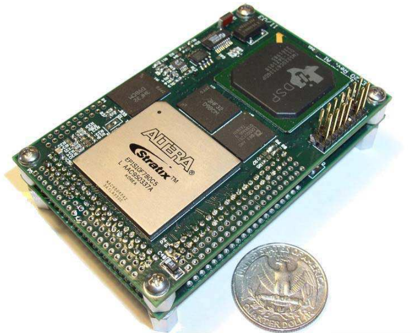
Figura 6 – Sistema de piloto automático de avião baseado em SoPC. O lado superior da placa contém um FPGA com processador NIOS embarcado, um processador DSP e memória. O lado inferior contém um receptor GPS, um conversor A/D, giroscópios e acelerômetros nos três eixos, um sensor de velocidade do ar e um sensor de altitude [31].
