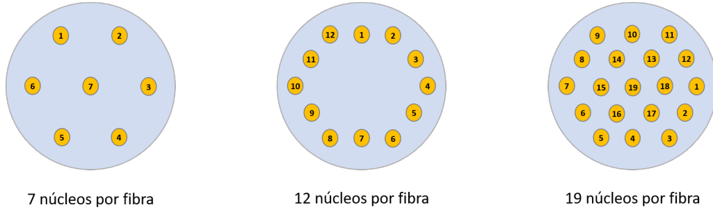
Figura 3.1: Fibras com 7, 12 e 19 núcleos.
