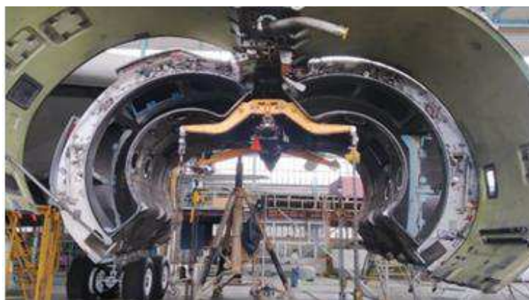
Figura 6 - Pylon sem o motor
