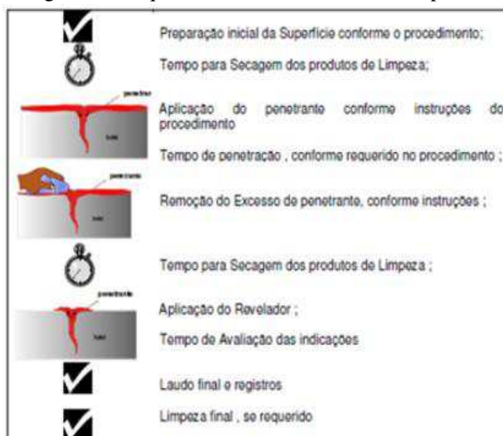
Figura 7 – Sequência de atividades do ensaio por LP
