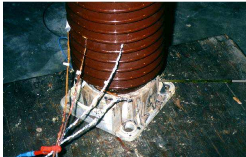
Fig. 6.25 – Termopares T3, T4, T5 e T6 fixados ao pára-raios com medição em um único termômetro.
