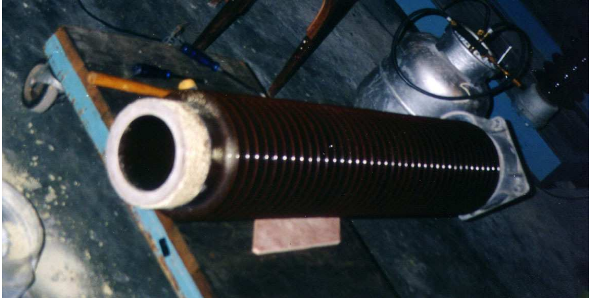
Fig. 6.7 - Fotografia do invólucro de porcelana do pára-raios de 96kV.
