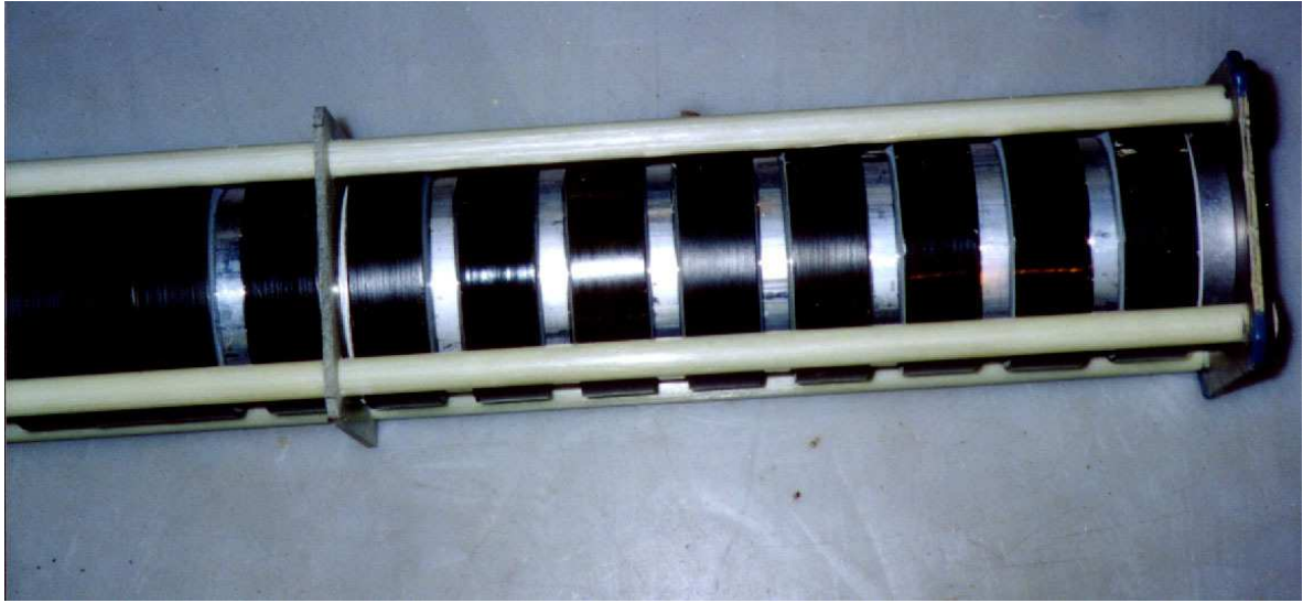
Fig. 6.8 – Fotografia dos absorvedores de alumínio em forma de disco( branco) e elementos de ZnO(preto).
