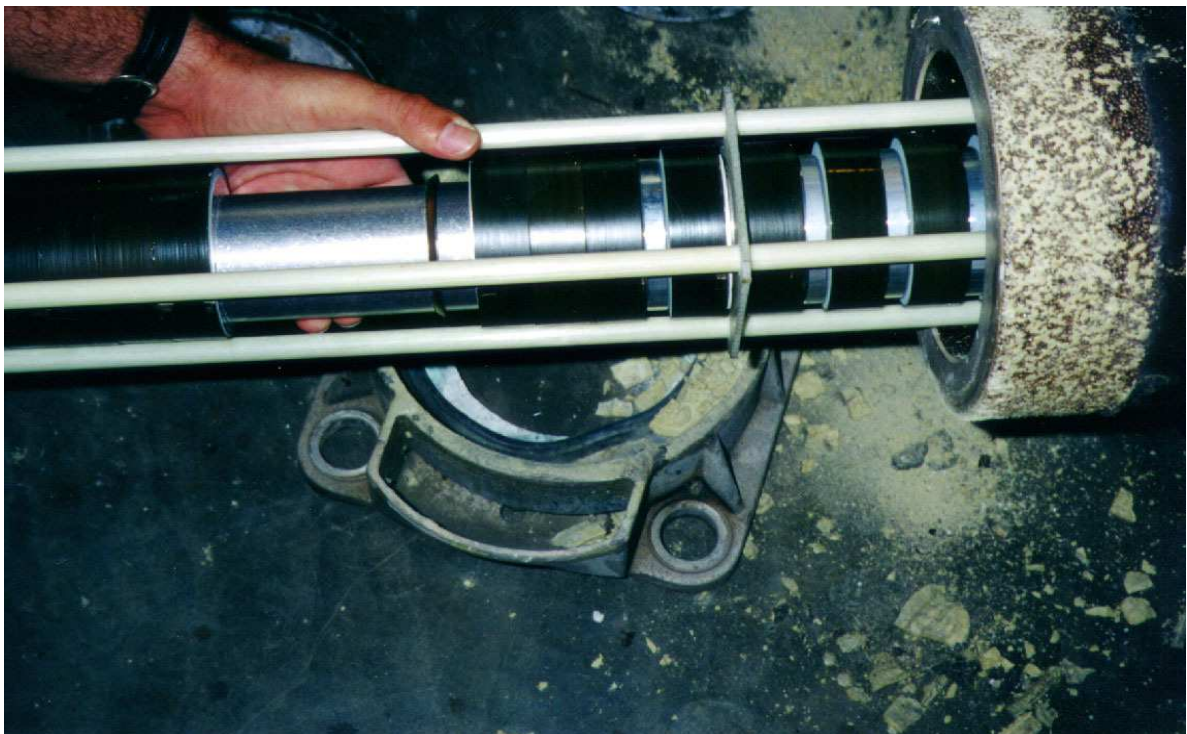
Fig. 6.9 – Fotografia do espaçador de alumínio em forma de tubo( branco) e elementos de ZnO(preto).
