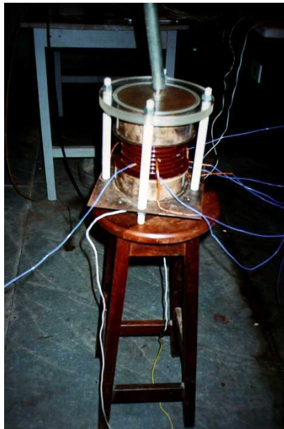
Fig. 6.4 - Fotografia da secção de teste de um pára-raios.
