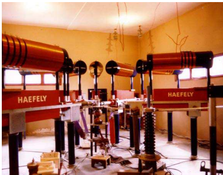
Fig. 6.21 - Gerador de impulsos de corrente do DEE/UFPB.
