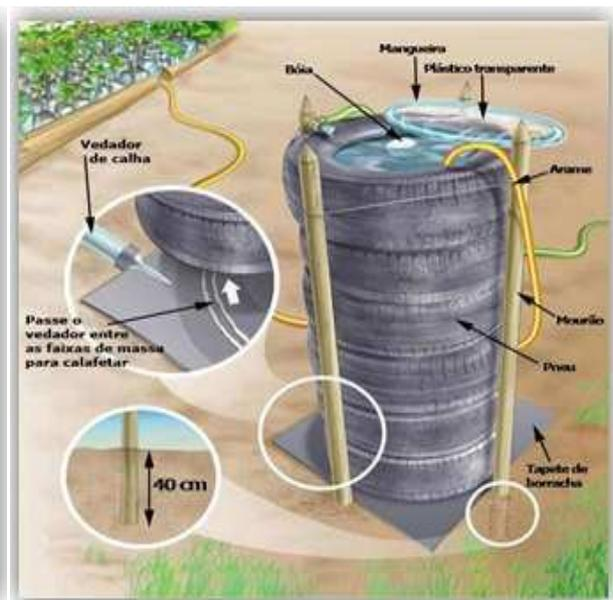
FIGURA 9 – Caixa-d'água feita a partir de pneus usados. Fonte: Globo Rural.
