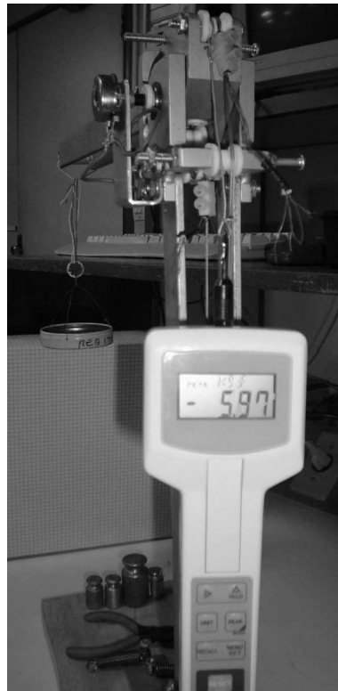
Figura 4.7: Medição do esforço para início do acionamento da alavanca.
