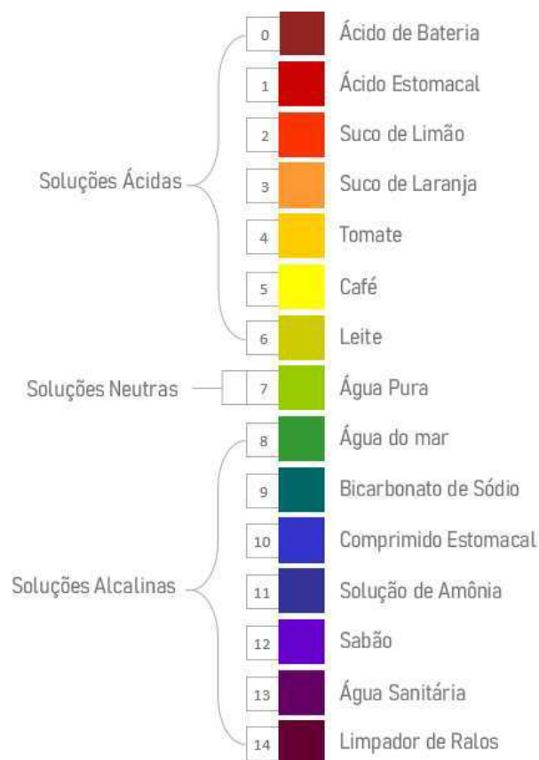
Figura 33 – Escala de pH e o grau de acidez de algumas substâncias comuns.
