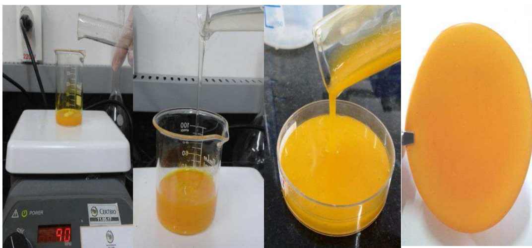
Figura 13: Etapa de obtenção da membrana de quitosana/curcumina .
