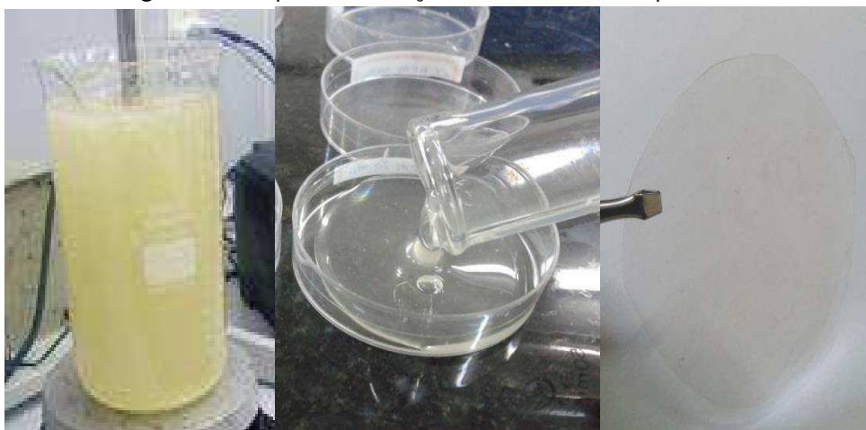
Figura 12: Etapas de obtenção da membrana de quitosana.
