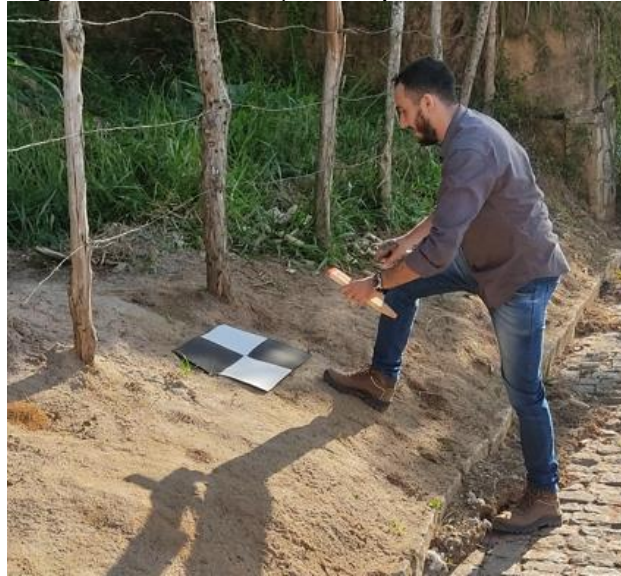
Figura 15 - Demarcação dos pontos de controle.
