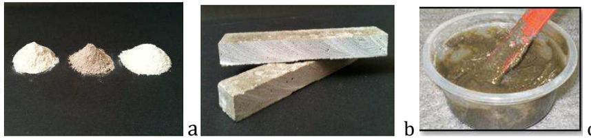
Figura 1 (a), (b) e (c). Resíduos de caulim, mármore e granito, mistura com a resina e compósitos.
