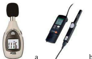
Figura 1. Equipamentos utilizados: Medidor de nível de pressão sonora-decibelímetro (A); Sensor de emissão de dióxido de carbono (B).
