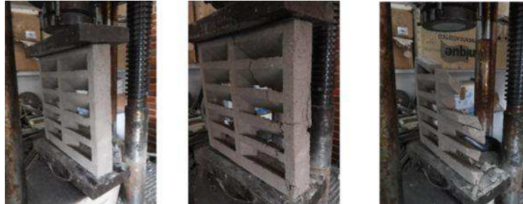
Figura 4. Processo do ensaio de resistência à compressão.
