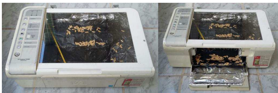
Figura 1. Protótipo do secador solar construído.
