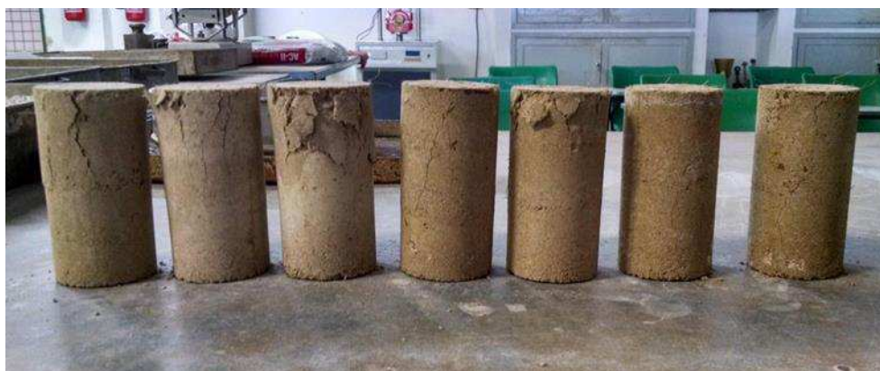
Figura 2. Corpos de prova pós-ruptura em prensa hidráulica.
